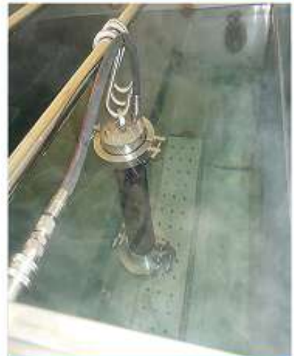
Basınç Test Havuzu
